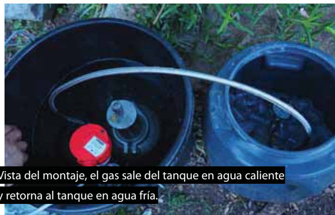
Empleo de la línea de purgado para sacar los últimos restos de gas
