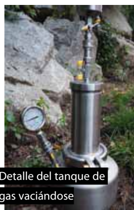
Se puede caldear el tanque de gas para que salga todo el gas
