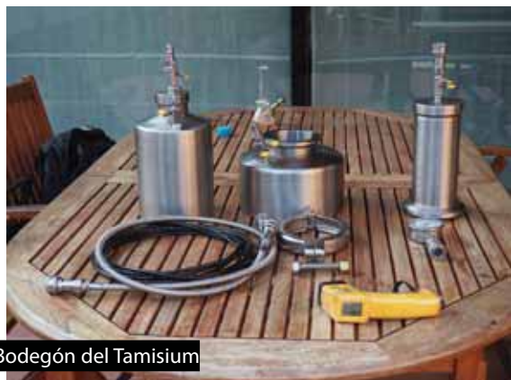
Manguera de conexión entre los dos tanques, manguera de purgado y filtros.
